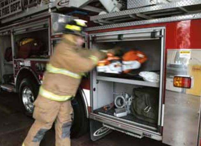
Pierce® 车身配备直接从消防车最为坚固的底盘车架纵梁向外延伸的侧架。因此，我们能够提供 227 千克的器材箱底板承重和 10 年保修的车身结构。双向滑出式托盘、倾斜托盘、底板托盘、工具箱、摆出式工具板和可调节的隔板更令每一寸空间都能充分利用。
