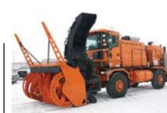
2009年 H-SERIES路面抛雪卡车诞生。该卡车采用专门为高海拔/偏远山区路面等恶劣环境设计的全新机械抛雪头。
