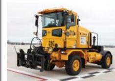
2007年 HT-SERIES亮相。凭借其“瑞士军刀式”扫雪底盘，该卡车可以安装各种扫雪犁、扫雪刷和其他附件，以适应变化无常的机场除雪环境。
