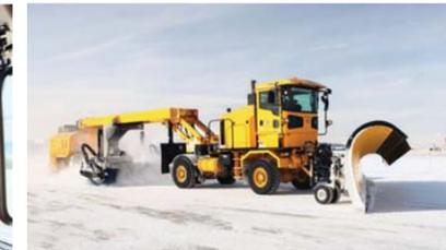
可安装任何品牌的拖带式扫雪刷、扫雪犁附件或底部刮雪机
